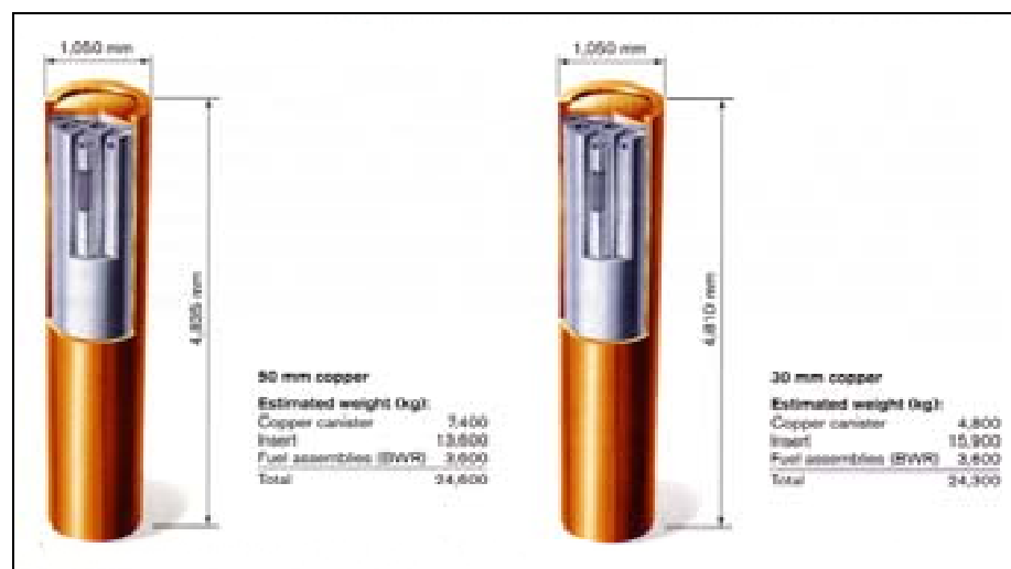
Figur 6.1. Mått och viktangivelser för kapsel med 50 mm och 30 mm väggjocklek (FUD-program 2001).
